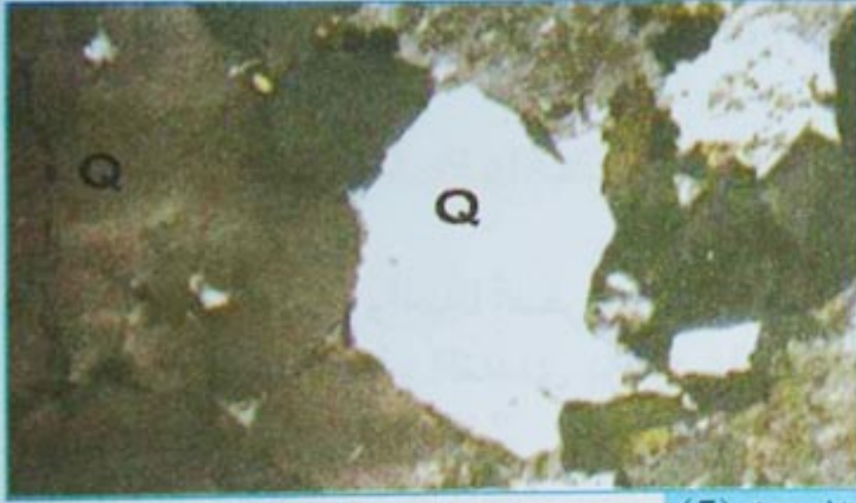
الوثيقة (5) صورة لشريحة معادن الكوارتز (Q) تحت المجهر المستقطب بالخلل
