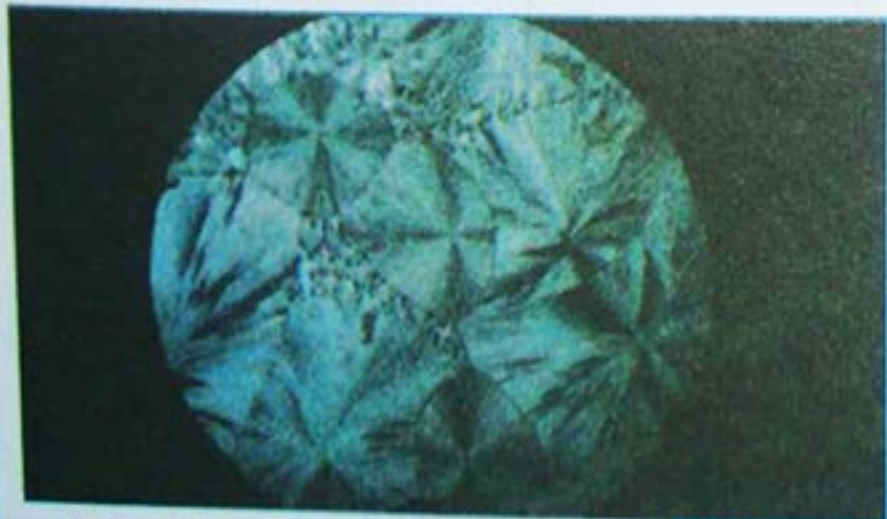
الوثيقة (6) صورة بالمجهر المستقطب لنتائج الشريحة التي وضعت فوق الحمام المائي
