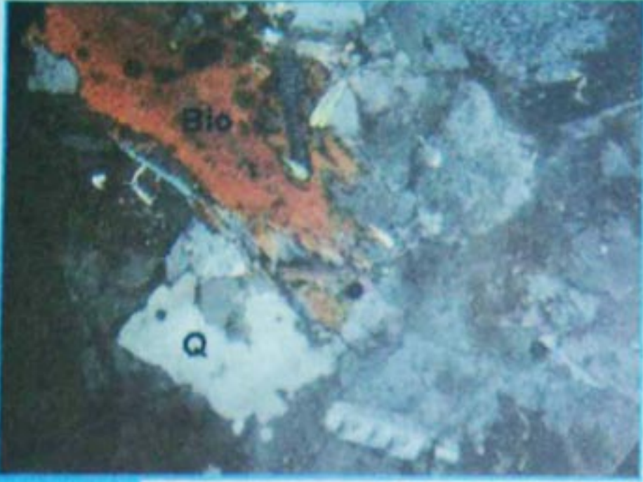
صورة لشريحة صخر الغرانوديوريت تحت المجهر المستقطب بالغلل - Q - كوارتز - BIO - بيوتيت الوثيقة (5)
