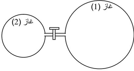
يمثل الشكل المقابل خزانان ، الخزان (1) حجمه  $v_1=20 \ell$  و الخزان (2) حجمه  $v_2=5 \ell$  موصولان بأنبوب مُزوّد بصمام . الخزانان موجودان في نفس درجة الحرارة  $t=30^\circ \text{C}$  . نضع في الخزان (1) غاز تحت ضغط  $P_1=2 \cdot 10^5 \text{ Pa}$  و نضع في الخزان (2) كمية من غاز آخر قدرها  $n_2=0,8 \text{ mol}$  . نعتبر الغازان مثاليان .
